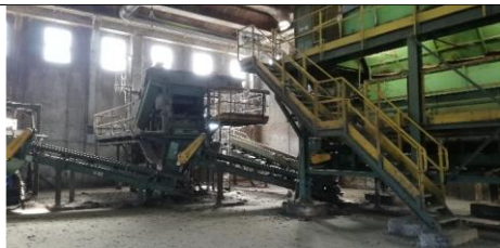
Separazione degli inerti dal compost
