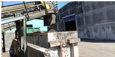
Separazione degli inerti dal compost
